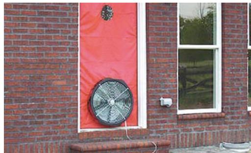
**Test Blowerdoor** (test de mesure de la pression différentielle) Cette méthode permet de vérifier l'étanchéité à l'air d'un bâtiment et de localiser les fuites d'air en injectant à l'intérieur un brouillard artificiel ou en utilisant un thermoanémomètre.
